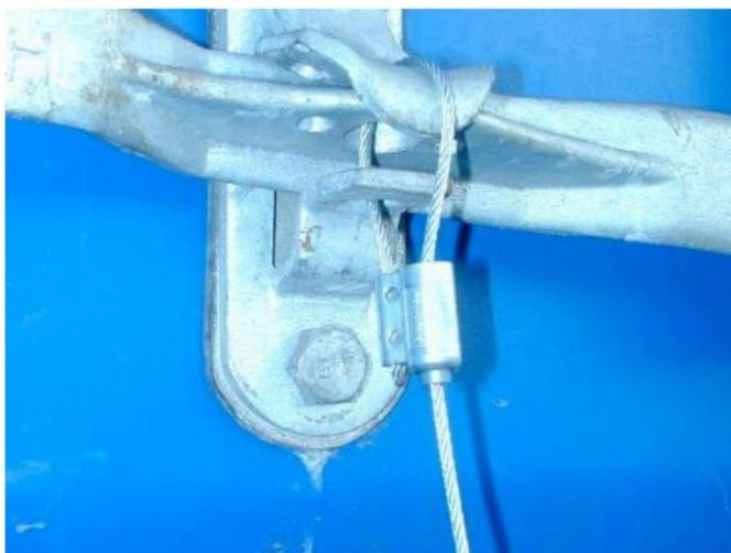
**Descripción:** Estos pueden ser fabricados con cuerpos de acero o plástico y su resistencia depende del grosor del cable y del mecanismo que se encuentra dentro del cuerpo del sello.
